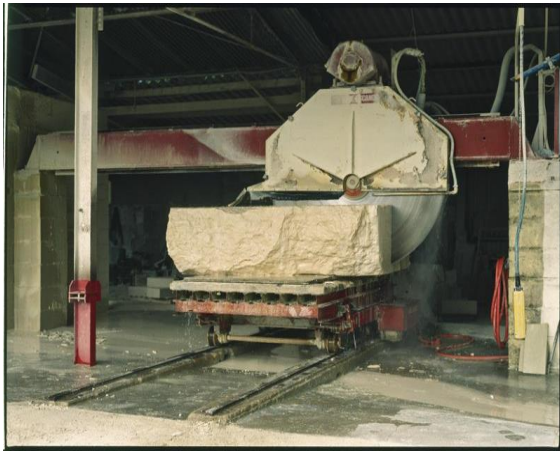
Débitage de calcaire dans une carrière de St-Aigny (Indre) Cl. Robert Malnoury, 1996
